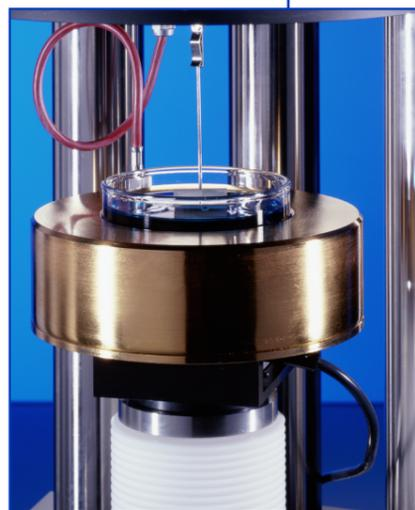
TV 70NM – безмагнитная жидкостная терморубашка с демантирующейся системой перемешивания
