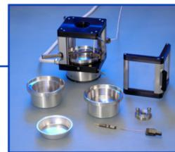
TEC 250/DCAT – электрическая термостатируемая ячейка с комплектующими
