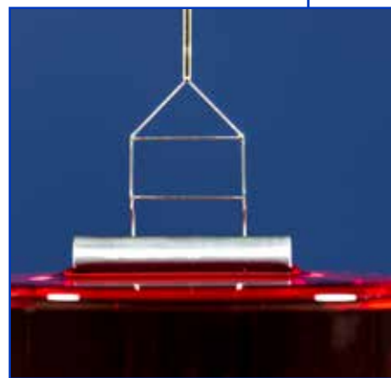
Определение плотности жидкости с помощью эталонного образца DIS 11
