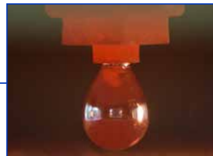
Капля расплава алюминия на конце капилляра нагревательного модуля NHD 700
