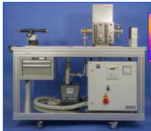
Оптический прибор для работы при высоких температурах в вакууме или в атмосфере защитного газа OCA 25-HTV 1800
